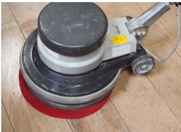
17) Grunnrens med polermaskin og Osmo Vask- og Pleiemiddel
