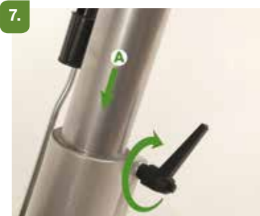
Monter støvrøret (A) og staget for løfting av valsen (B).
