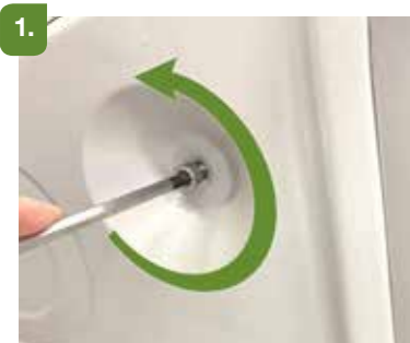
Drei skruen mot klokken og åpne beskyttelsesdekselet.
